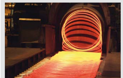
Trabajo en caliente de chapas metálicas y fabricación de alambre
