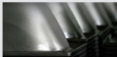
Bañeras como productos de embutición profunda
