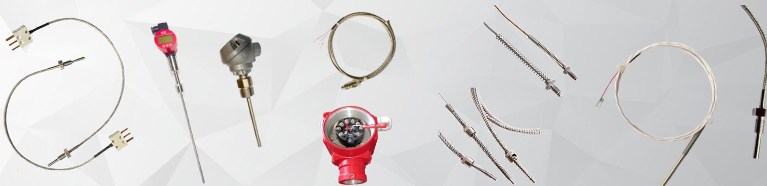
Los sensores de temperatura RTD son adecuadas para aplicaciones en las que son esenciales la precisión y la estabilidad para mantener un control adecuado en aplicaciones por debajo de los 650°C. Los termistores son mejores para aplicaciones en las que se desea una rápida respuesta temporal y un alto cambio en la resistencia en un rango limitado de temperatura.
